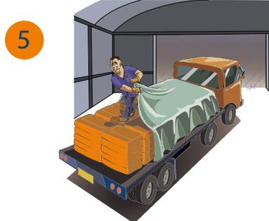
5 Al transportar el cemento se debe cubrir con plásticos, lonas o materiales impermeables, igualmente debe protegerse la plataforma del vehículo sobre la cual se coloca el cemento. No descargar cuando esté lloviendo, o protegerlo adecuadamente. Todo saco que se humedezca debe ser consumido inmediatamente.
